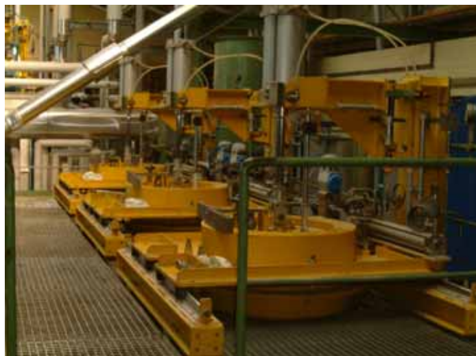
Abb.: CO 2 -Extraktionsanlage zur Herstellung von Margosa Extract
