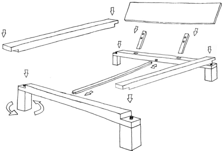
1. Je 2 FüÙe mit einem Kopf- / Fuß-Bettbalken zusammenstecken. (Bei einer Ausführung mit Rückenlehne müssen die Stecklöcher für die Kopfstütze oben, sichtbar sein)
